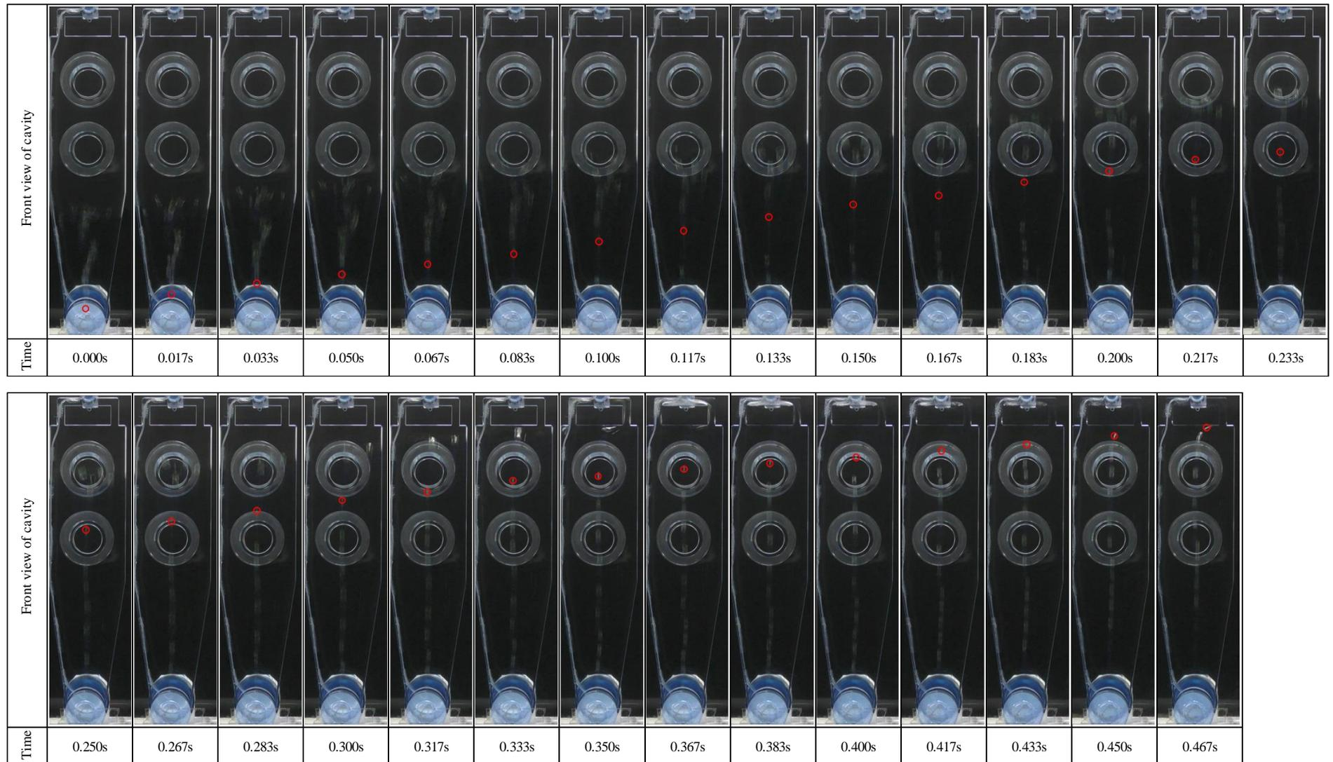
Fig.A-1  $V_{plunger}=0.1\text{m/s}$  におけるキャビティ充填挙動および気泡上昇挙動 (N1)
